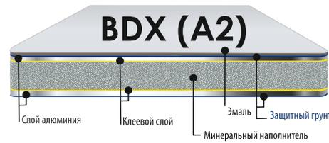
Панели обладают высокими огнеупорными характеристиками. Одобрены для использования в высотном строительстве, а также для зданий повышенной пожарной опасности в качестве облицовки фасадов, оконных и дверных проёмов, в устройстве внутренних углов зданий.
