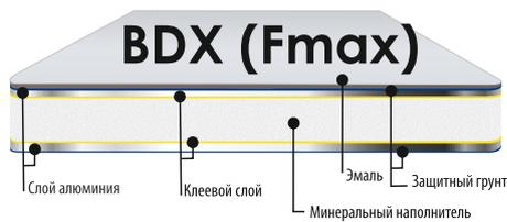
Панели применяются в устройстве навесных вентилируемых фасадов в качестве облицовки основной плоскости фасада и обрамления дверных и оконных проёмов.
