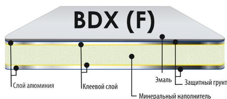
Панели применяются в устройстве навесных вентилируемых фасадов в качестве облицовки основной плоскости фасада.
